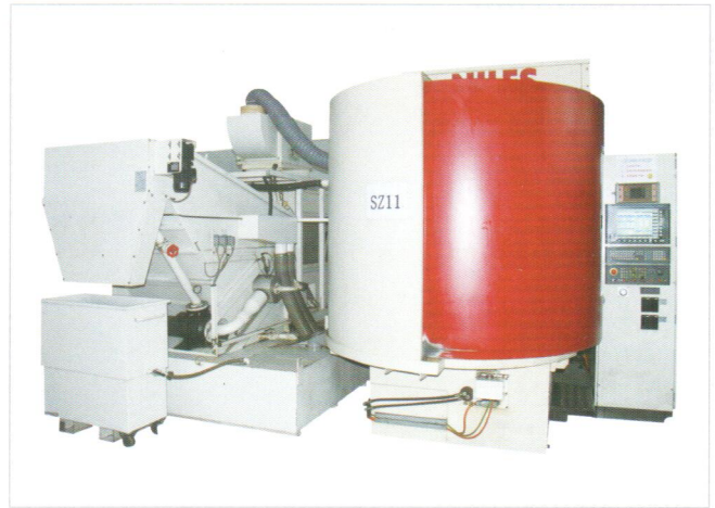
NILES-400磨齒機 精度可達到DIN3級
