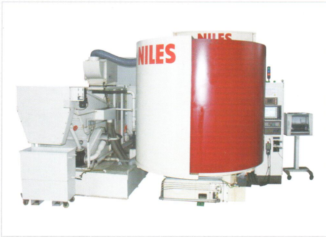
NILES-1200磨齒機 精度可達到DIN3級
