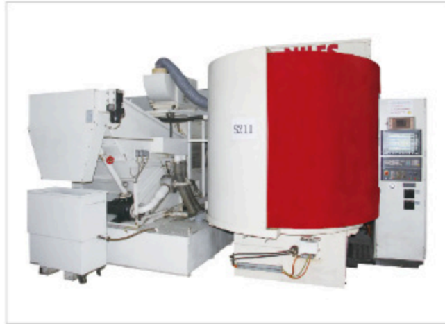
NILES-400磨齒機 精度可達到DIN3級
